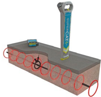
Abb. 7 Indirekte (induktive) Einkopplung eines Signals
