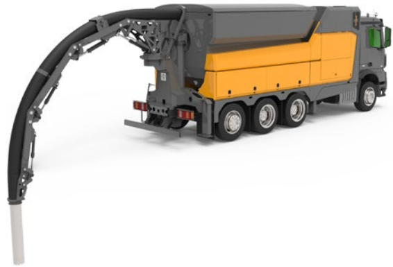
Abb. 11 Saugbagger großer Leistung auf LKW-Fahrgestell
