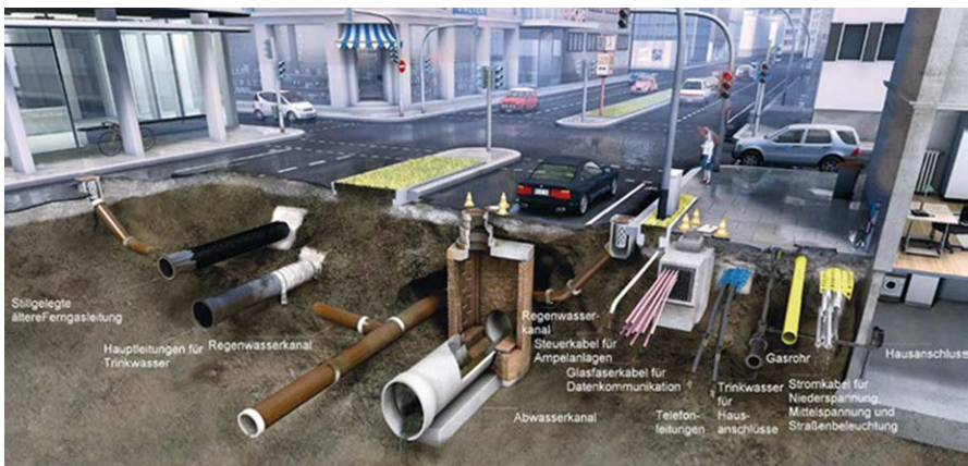
Bild 1 Versorgungsleitungen in der Straße (Quelle: E.ON)
